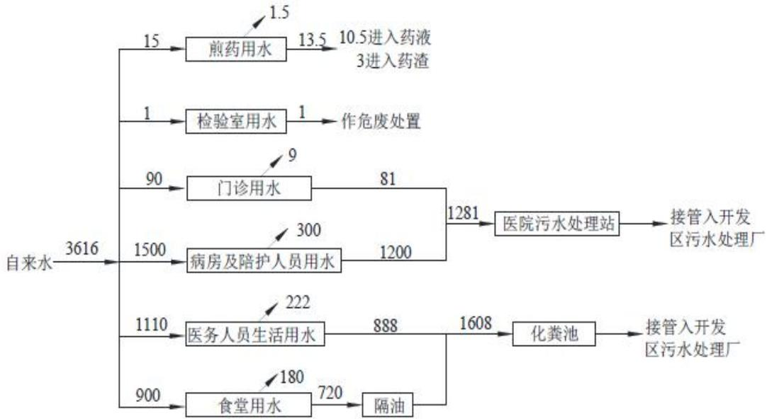
图 3-4 项目水平衡图(t/a)
