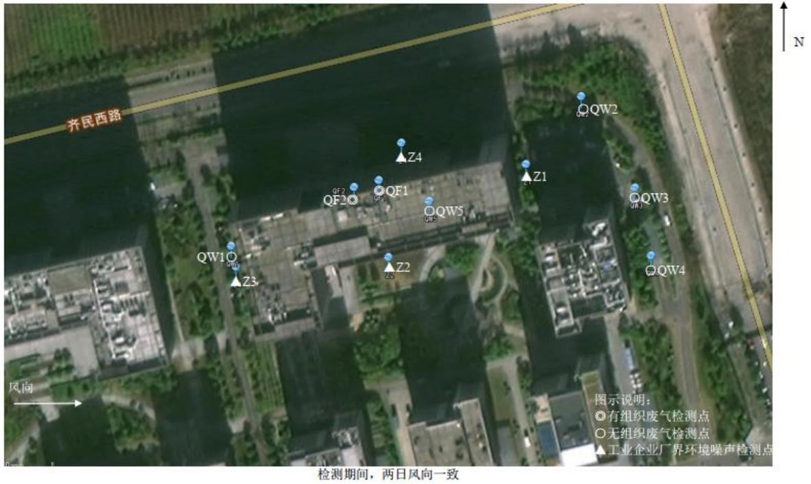
图 3-1 废气、噪声检测点位示意图
